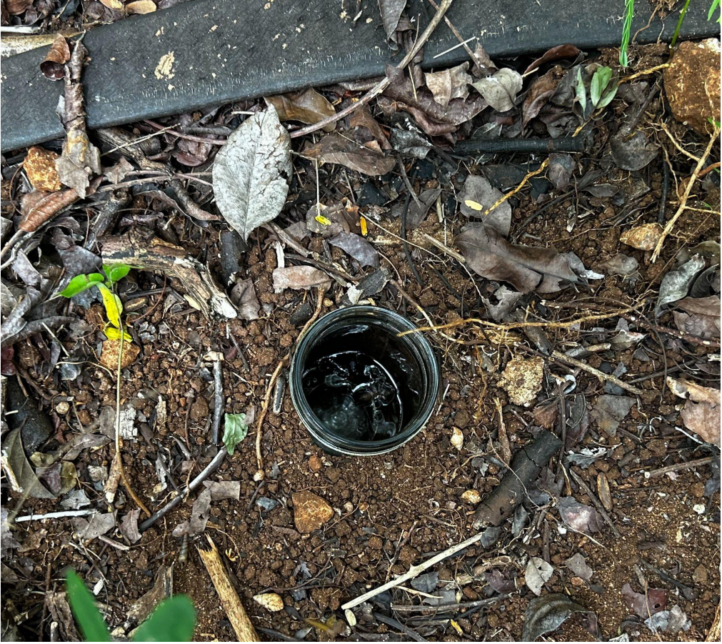
Fig. 2. Trampa de caída instalada para la captura de artrópodos terrestres.
